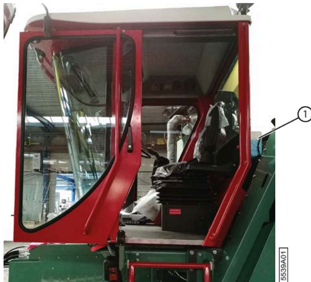
Fig. 14: Réservoir du liquide lave-glace
