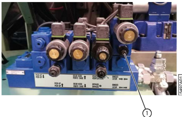
Fig. 162: Régler la vitesse des aiguilles du système de liage ficelle.
