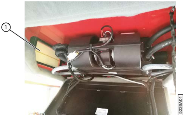
Fig. 168: Filtre à air dans la cabine
