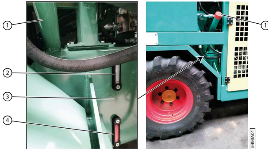
Fig. 150: Contrôler le niveau de carburant
