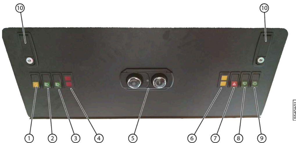
Fig. 16: Boutons de commande à l'avant dans le toit de la cabine
