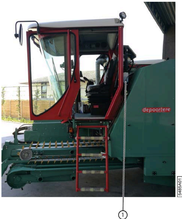
Fig. 118: Réservoir du liquide lave-glace
